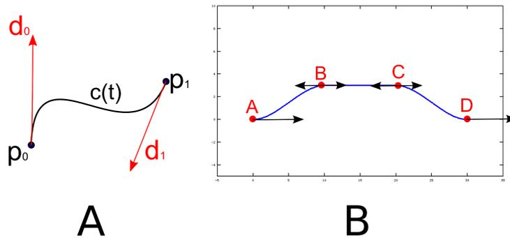
FIGURE 1 – A : Courbe de Hermite ; B : Design d'un pont passant par 4 points.
